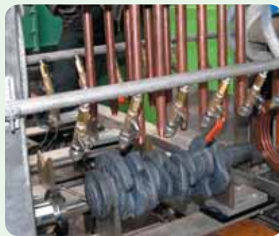
▲ 축통전 및 코일 동시자화 Contact & Coil Multi magnetization
