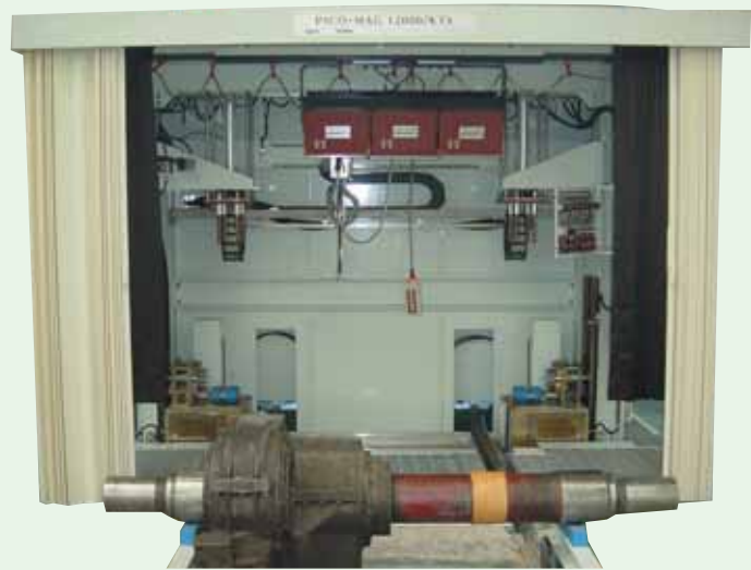
▶ KTX 차축자분탐상기 / PICO-MAG 12000 축통전자화, 코일자화 적용 / Contact, Coil Magnetizing
