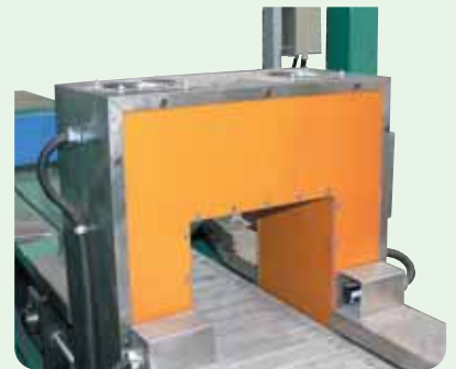
▲ 탈자기(콘베어식) Demagnetizaion / Conveyor Type
