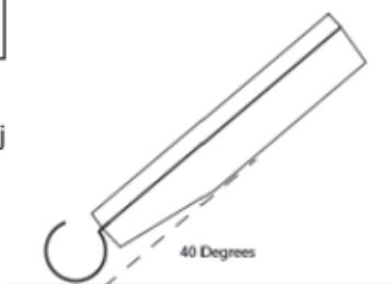
**Przyłożyć sprężyste elektrody do mierzonego materiału, unikając nadmiernego nacisku, pod kątem ok. 40°. Wszystkie 3 sprężyny pomiarowe muszą pozostać w stałym, pewnym kontakcie z materiałem.**
