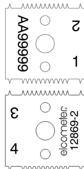
*Opmerking: Volgens de aanbevelingen van de ISO/JIS standaard moet u de messen vervangen als de bovenkant van de roosterkammes is afgevlakt tot 0,1 mm.*
