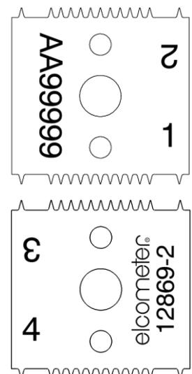
*Hinweis: Die ISO/JIS-Norm empfiehlt den Austausch des Schneidwerkzeugs, wenn die Schneidkante auf 0,1 mm abgeflacht ist.*
