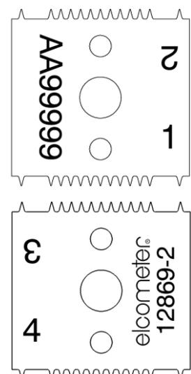
注：ISOとJIS規格では、刃先の幅が0.1mmになったら取り替えるように指示しています。
