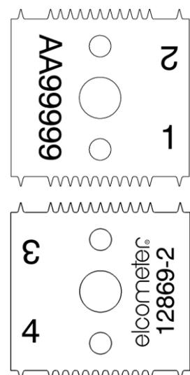
*Nota: El estándar ISO/JIS recomienda sustituir la herramienta de corte cuando la parte superior de las cuchillas se haya aplanado a 0,1 mm.*
