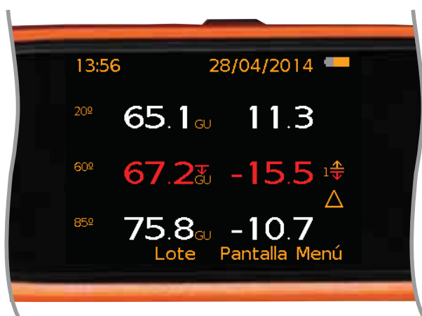
Lecturas y modo diferencial con fallo de un límite (fuera del límite mínimo)
