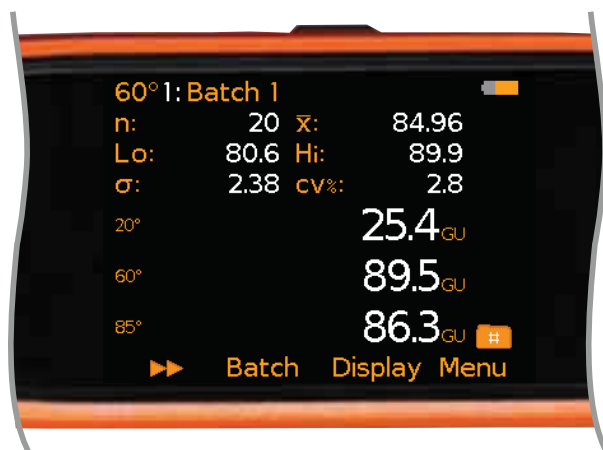
Mesure de brillance sous les 3 angles, dans un lot avec statistiques
